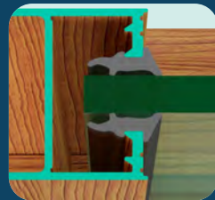
Doble Vinil Cuña Aumenta Aislamiento Acústico
