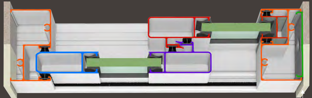
Cerco Fijo da Apariencia de un Perfil Integrado al Contramarco
