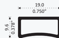
2504 TUBO RECTANGULAR DOS VISTAS Longitud 6.10 m TDV 1 m
