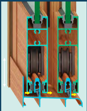
Mejor Salida de Agua por: - Riel con Pared Interior Alta - Inclinación de Riel - Drenes Inferiores
