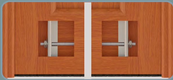
Cerco Chapa con Refuerzos en Paredes Interiores Dando Resistencia al Apretar el Tensor
