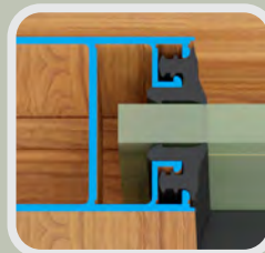
Doble Vinil Respaldo Aumenta Aislamiento Acústico
