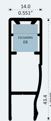
Marco Armado con Escuadra de Botón EB AJUSTA Y CIERRA EL CORTE
