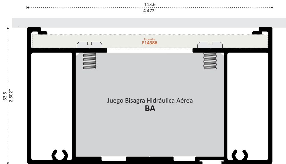
14386 CANAL BISAGRA Longitud 6.10 m
