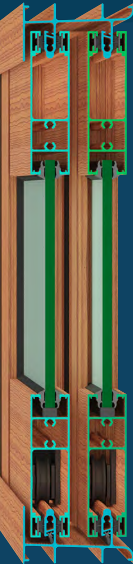
Mejor Salida de Agua por: - Riel con Pared Interior Alta - Inclinación de Riel - Drenes Inferiores
