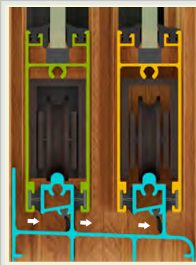
Mejor Salida de Agua por: - Riel con Pared Interior Alta - Inclinación de Riel - Drenes Inferiores
